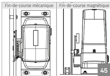
**01** • Placer la plaque de fin de course d'ouverture dans la crémaillère de sorte qu'elle puisse déclencher le fin de course dans le moteur et avant que le portail atteigne la butée d'ouverture. Le fin-de-course mécanique déclenche lorsque la plaque touche dans le ressort. Le fin-de-course magnétique déclenche lorsque l'aimant est aligné avec le lecteur du moteur (imag. 45).
