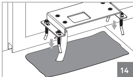
**04** • Insérez la plaque avec les vis dans la base à béton encore frais et nivelez horizontalement avec un niveau. Aligner également parallèle au portail, tout en gardant une distance de 60 mm entre eux, comme visible sur l'image 16.
