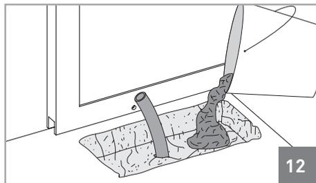
**02** • Remplir le trou avec du béton frais et lisser la partie supérieure où vous allez fixer la plaque.
