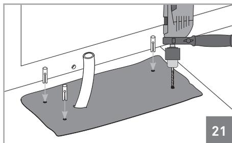
**03-** Faire quatre trous de  $\varnothing 18\text{mm}$  na sapata. dans la fondation. Placer les douilles métalliques M10 dans les trous.
