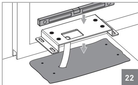
**04-** Placer la plaque de fixation sur la fondation en béton tout en respectant les distances de l'image 19. À l'aide d'un niveau, niveler horizontalement et serrer avec des vis M10.
