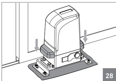
05- Remettre les couvercles latéraux dans le moteur pour cacher les vis.
