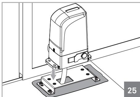
02- Placer le moteur dans la plaque de fixation.
