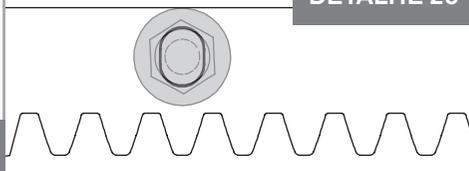
**01** • Mettez les vis et rondelles dans tous les trous de la crémaillère pour la fixer au portail. Elles doivent être placées au centre des trous ovalisés de la crémaillère, comme dans figure 29, de sorte que vous pouvez régler à la fin de l'installation, si nécessaire.
