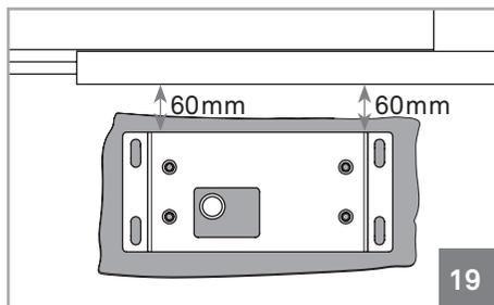
**01-** Placer la plaque de fixation sur la fondation et l'aligner parallèlement au portail, en gardant une distance de 60 mm entre eux, comme on le voit sur la figure 19.
