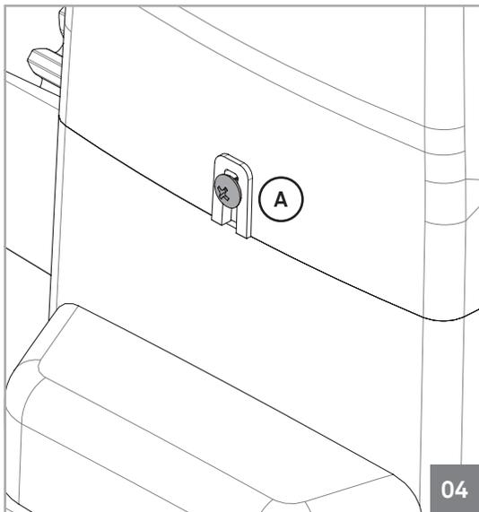
Pendant l'installation, il sera nécessaire ouvrir le capot du moteur, pour accéder aux divers composants à l'intérieur. Pour cela, desserrer légèrement les 2 vis identifiées avec (A) jusqu'à ce que le capot soit libre pour être enlevé.
