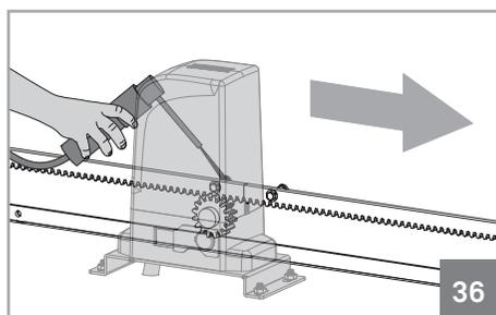
**07** • Retirer le morceau de crémaillère auxiliaire et ouvrir le portail jusqu'à ce que le pignon soit sur l'autre extrémité de la crémaillère. Souder la vis et rondelle.
