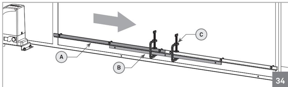
**05** • Fermez le portail encore un peu, laissant la crémaillère sans appui sur le pignon et appliquer un autre morceau de la crémaillère (A). Pour synchroniser les dents avec la pièce déjà installé, utilisez un morceau supplémentaire de crémaillère (B) et placez-le sous l'union des deux autres, en le tenant avec des crampons (C).
