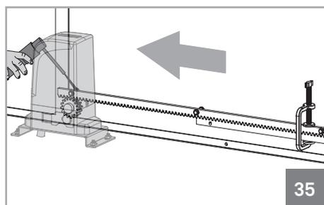
**06** • Ouvrez le portail jusqu'à ce que l'extrémité du nouveau morceau de crémaillère soit soutenu sur le pignon et souder la vis avec la rondelle.
