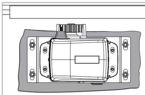
03- Aligner parallèlement au portail en laissant une distance de 63mm entre eux, comme visible dans l'image 26. Les trous ovalisés du moteur doivent être centrés sur les trous filetés de la plaque de fixation, comme visible en détail 26.
