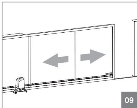
Afin que l'automatisme fonctionne normalement, fermez le déverrouillage et tournez la clé à la position initiale. Pour terminer fermez le couvercle (06) et effectuer une manœuvre pour confirmer le fonctionnement de l'automatisme.
