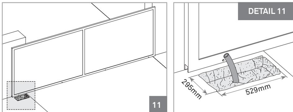
**01** • Faire un trou dans le sol pour créer une fondation en béton. Les dimensions indiquées sont celles recommandées dans la création de la fondation. Des tubes doivent être laissés au milieu du trou pour le passage des câbles d'alimentation et des accessoires, comme dans l'image 11.
